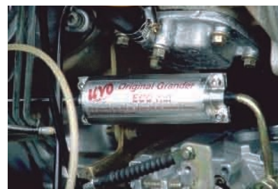
Exemplu de montaj pe conducta de alimentare cu benzină a unui motor cu ardere internă
